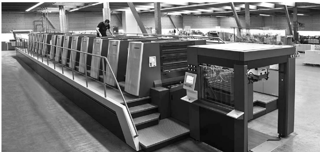
Mit der Abwärme der hochmodernen 10-Farb-Druckmaschine werden die Büros in der BuLu geheizt. (Fotos Stefan Grdic, BuLu)
